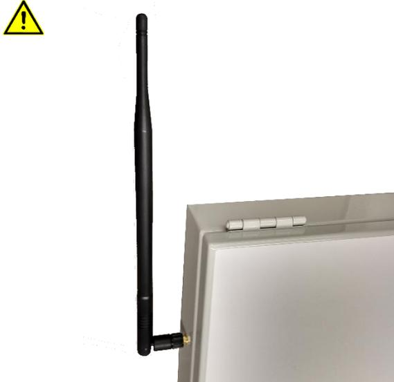
Avant de raccorder l'alimentation électrique, veillez à fixer l'une des antennes tiges faisant partie de la livraison, sur la paroi extérieure du boîtier.
